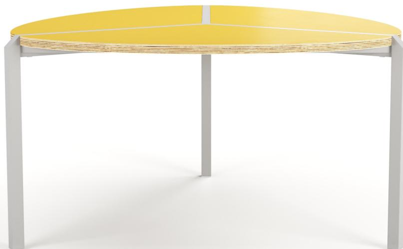
Mesa coletiva empilhável pensada para escritórios colaborativos, refeitórios e escolas. Sua estrutura é em aço carbono com pintura eletrostática epoxi. O tampo é dividido em três partes, entre as quais fica aparente a estrutura de aço, e é produzido em compensado laminado de madeira maciça revestido de Fórmica®. A Mesa Trevo pode ser produzida em alturas mais baixas para ambientes infantis.
