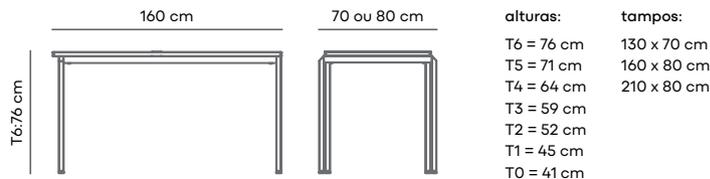
\*Os tampos em acabamento lynx são bipartidos nas dimensões 130 e 160 cm, e tripartido na dimensão 210 cm. Na versões de compensado, o tampo é fabricado em peça única.
